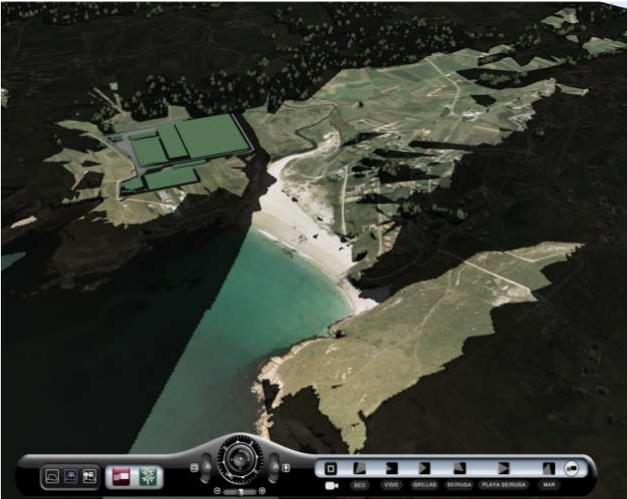
Figura 5. Representación de la cuenca visual inversa, calculada sobre el proyecto original.
